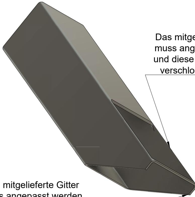
Das mitgelieferte Gitter muss angepasst werden und diese offene Fläche verschlossen werden.
