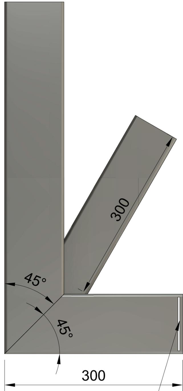
Schlitz für die Belüftungsclappe
